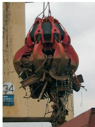
Polipi elettroidraulici per movimentazione di rottami metallici, scorie, massi e materiali alla rinfusa.
