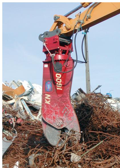
Cesorie idrauliche a rotazione continua per taglio materiali metallici
