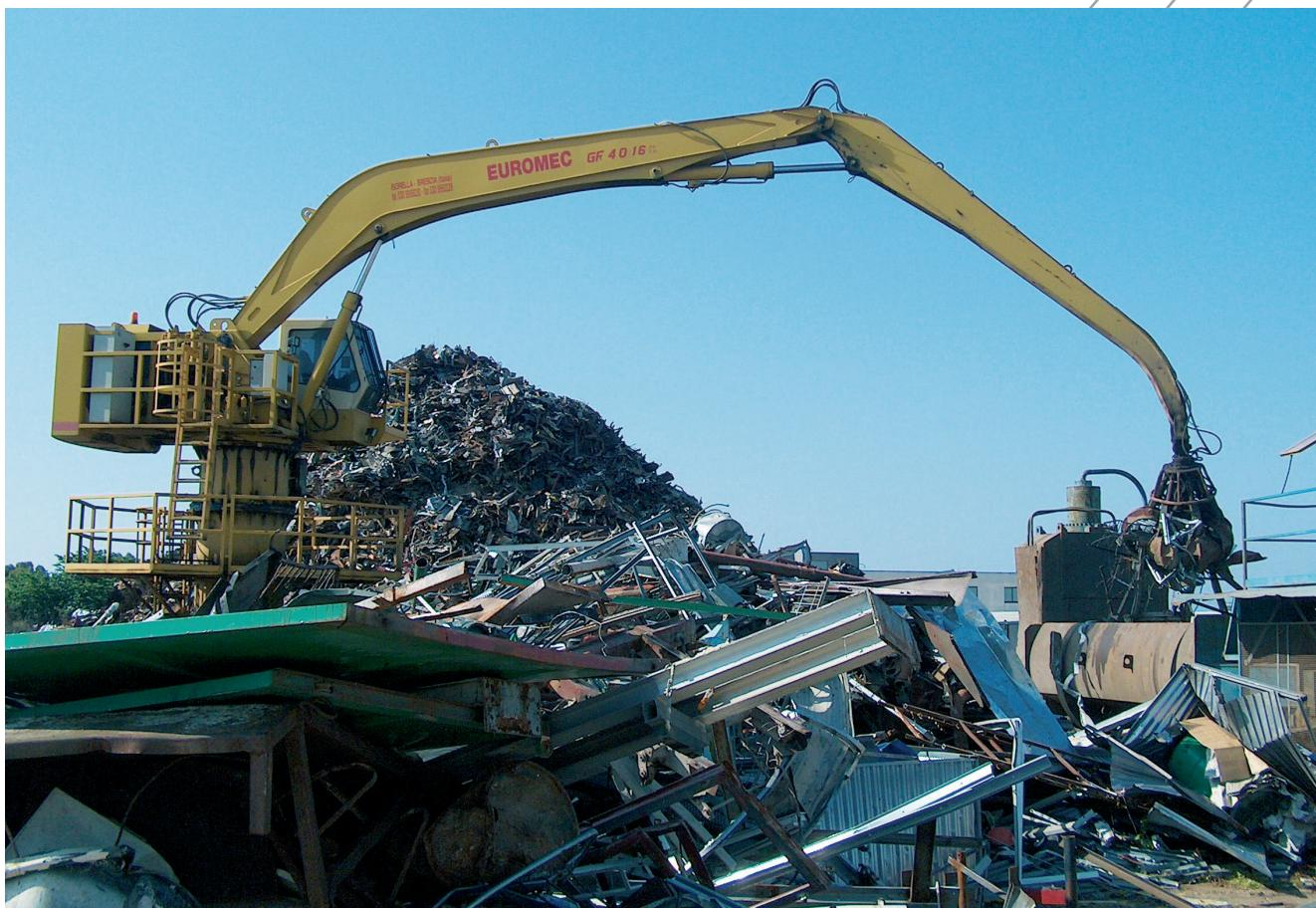
Gru fisse con doppi comandi elettro-idraulici proporzionali sia sulla torretta girevole, sia a distanza nella cabina della cesoia, della presa, del mulino.
