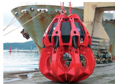
Grappins électrohydrauliques pour la manutention des ferrailles de métaux, scories, blocs et matériel en vrac.
