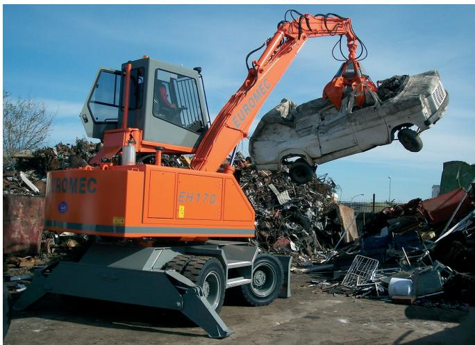
Caricatori semoventi idraulici.
