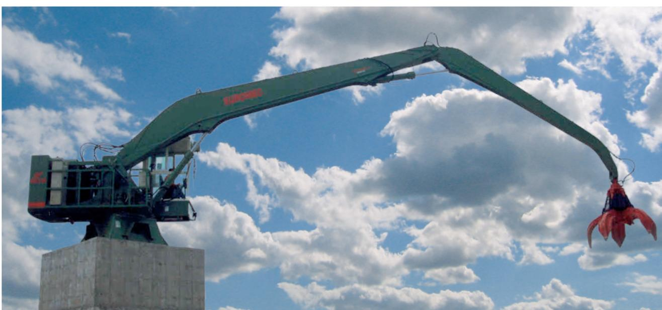
Gru fisse equilibrate con funzionamento elettrico o diesel, con comandi sulla torretta girevole servo-assistiti, per alimentazione mulini fino a 6000 CV.
