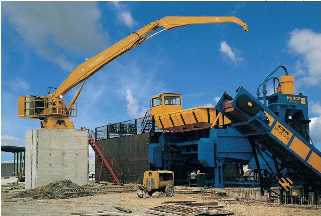
Grues fixes avec commandes à distance électro-hydrauliques proportionnelles, placées dans la cabine de la cisaille ou de la presse.
