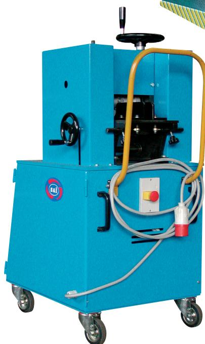
Spelacavi universali, per cavi corazzati in acciaio o piombo o in P.V.C., PTFE o gomma. In due versioni per cavi da 8 a 160 mm.
